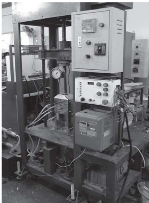
รูปที่ 1 เครื่องคาปิลารีโอมิเตอร์แบบอัตราเฉือนคงที่
