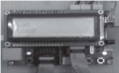
รูปที่ 6 LCD Module
