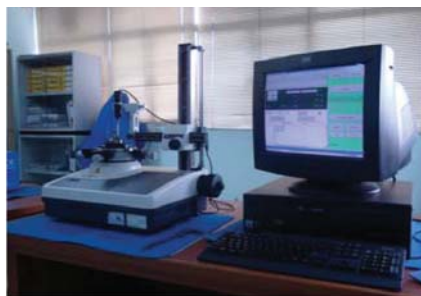
รูปที่ 4 การตรวจสอบคุณภาพผิว (ความเรียบ)
