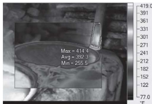
รูปที่ 11 ค่าเฉลี่ยอุณหภูมิของช่องระบายไอเสียของเตาปล่อง
