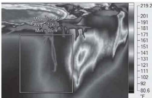
รูปที่ 13 อุณหภูมิโดยเฉลี่ยบริเวณผนังเตาปล่องสำหรับต้มเกลือ
