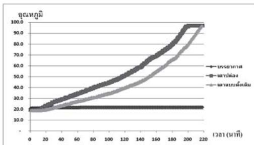
รูปที่ 9 กราฟเปรียบเทียบอุณหภูมิน้ำที่ทำการทดสอบของเตาทั้ง 2 แบบ
