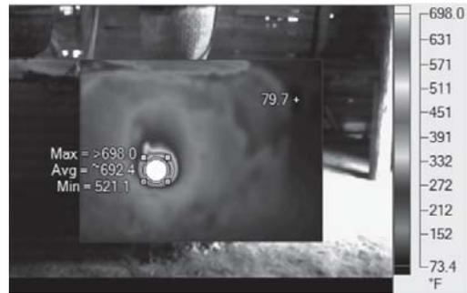
รูปที่ 10 แสดงค่าเฉลี่ยอุณหภูมิของช่องระบายไอเสียของเตาแบบดั้งเดิม
