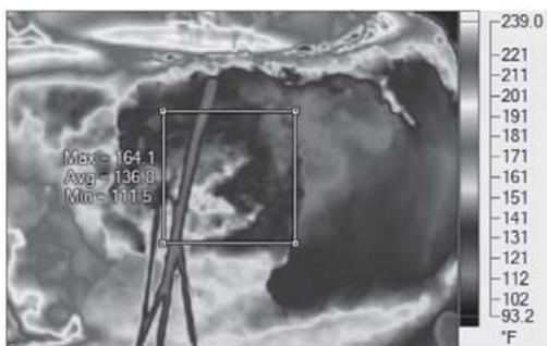
รูปที่ 12 อุณหภูมิโดยเฉลี่ยบริเวณผนังเตาแบบดั้งเดิม
