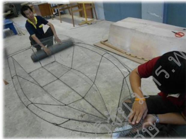
รูปที่ 4 โครงเหล็กเสริมภายในของเรือคอนกรีต
