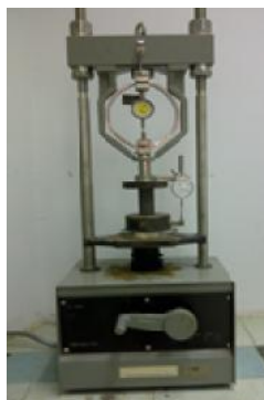
รูปที่ 2 การทดสอบแรงอัดโดยปราศจากแรงด้านข้าง
