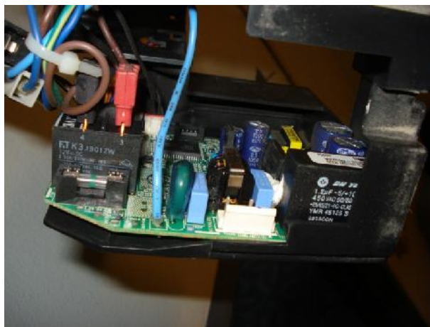
รูปที่ 8 ดัดแปลงวงจรอิเล็กทรอนิกส์ให้ใช้กับมอเตอร์กระแสตรง
