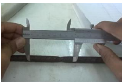
รูปที่ 8 วัดค่าการยืดตัวและลักษณะการวิบัติ
