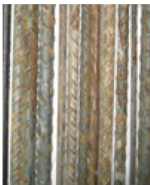
รูปที่ 3 ตัวอย่างเหล็กข้ออ้อย (DB 12)
