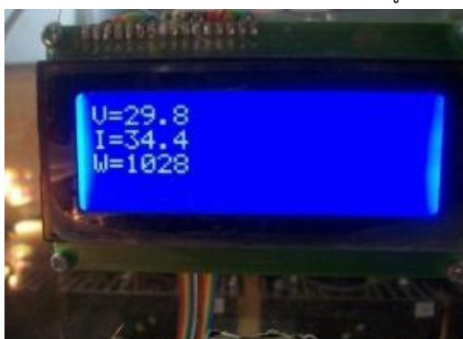
รูปที่ 5 หน้าจอแสดงผลขณะอิเล็กทรอนิกส์ไหลดทำงานเต็มพิกัด
