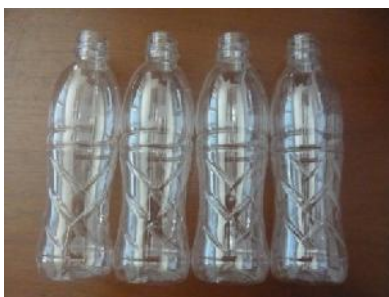
รูปที่ 18 ขวดพลาสติกที่ขึ้นรูปแล้ว
