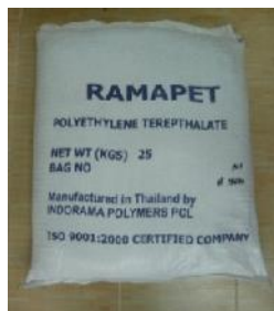
รูปที่ 6 พลาสติก PET Resin Grade : N1
