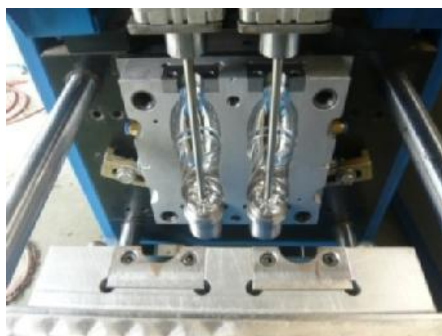
รูปที่ 12 การจับยึดแม่พิมพ์
