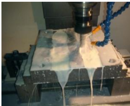
รูปที่ 10 ขึ้นรูปแม่พิมพ์เป่าขวดพลาสติก
