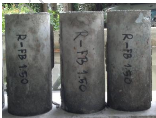
รูปที่ 2 คอนกรีตตัวอย่างที่ใช้ทดสอบกำลังอัดและกำลังดึง
