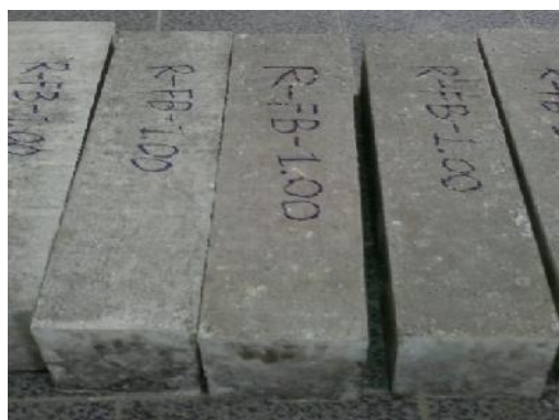
รูปที่ 3 คอนกรีตตัวอย่างที่ใช้ทดสอบกำลังดัด
