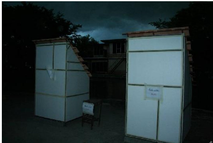
รูปที่ 3 อาคารจำลองที่ผนังด้านในมีการติดตั้งแผ่นใยชีวภาพอัตราส่วน CC50 และแผ่นขึ้นไม้อัดชนิดอัดราบทั่วไป
