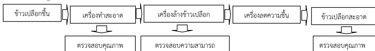
แผนผังการทดสอบสมรรถนะการทำงานของเครื่องล้างข้าวเปลือก
