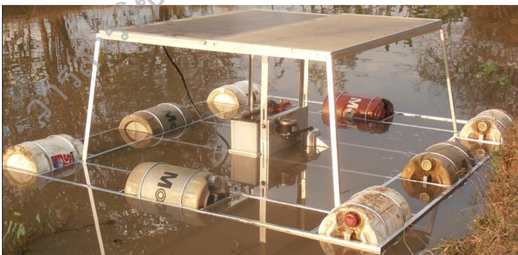
รูปที่ 1 ต้นแบบเครื่องกลเติมอากาศแบบเวนจูรีพลังงานแสงอาทิตย์สำหรับแหล่งน้ำสาธารณะ
