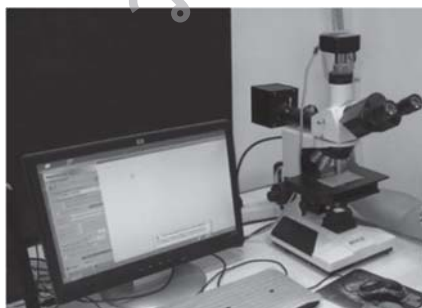
รูปที่ 4 การใช้กล้องไมโครสโคปเพื่อวัดขนาดของรูพรุนของผ้าทั้ง 5 ชนิด
