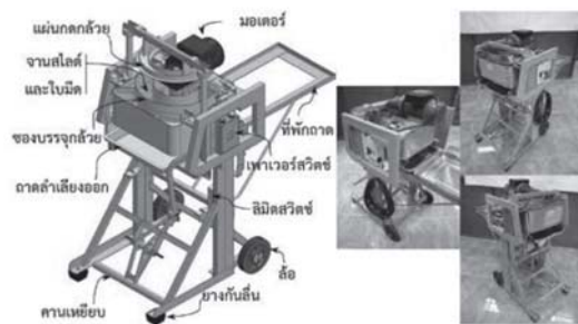
รูปที่ 5 เครื่องจักรที่ปรับปรุงขึ้นใหม่ มีขนาดโดยรวมกว้าง 0.56 x ยาว 0.64 x สูง 1.38 เมตร มวลประมาณ 60 กิโลกรัม
