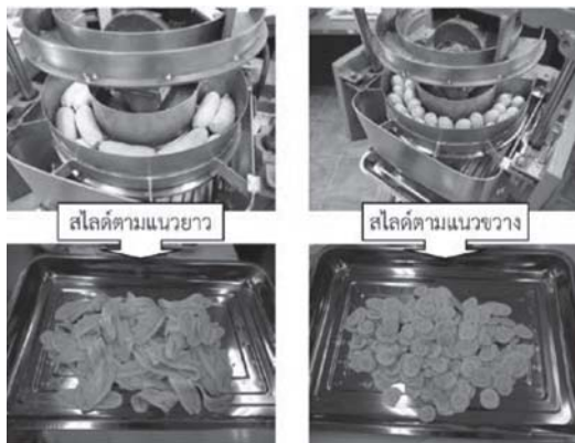
รูปที่ 8 รูปแบบการบรรจุผลกล้วยลงในเครื่องจักร เพื่อให้ได้รูปแบบการสไลด์ในแนวยาวและแนวขวาง
