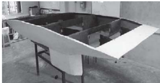
รูปที่ 3 แบบและการสร้างตัวถังไฟเบอร์กลาสของรถต้นแบบ (หน่วย: เซนติเมตร)
