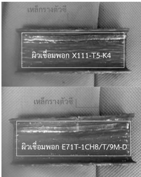
รูปที่ 2 ผิวเชื่อมพอกจากกรรมวิธีการเชื่อมแมกด้วยลวดเชื่อมไส้ฟลักซ์เกรด X111-T5-K4 และ E71T-1CH8/T/9M-D
