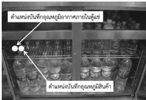
รูปที่ 2 ตำแหน่งติดตั้งสายวัดอุณหภูมิอากาศและอุณหภูมิสินค้าในตัวแช่
